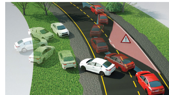
Интегрированная система контроля устойчивости (VSM) Помогает избежать столкновений или снизить их последствия, оптимальным образом распределяя тормозные усилия, чтобы сохранить траекторию движения и воспрепятствовать срыву автомобиля в занос.
