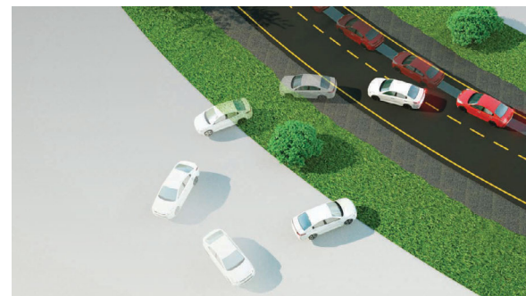
Система контроля торможения в поворотах (CBC) Позволяет увереннее проходить повороты, не уходя в занос.
